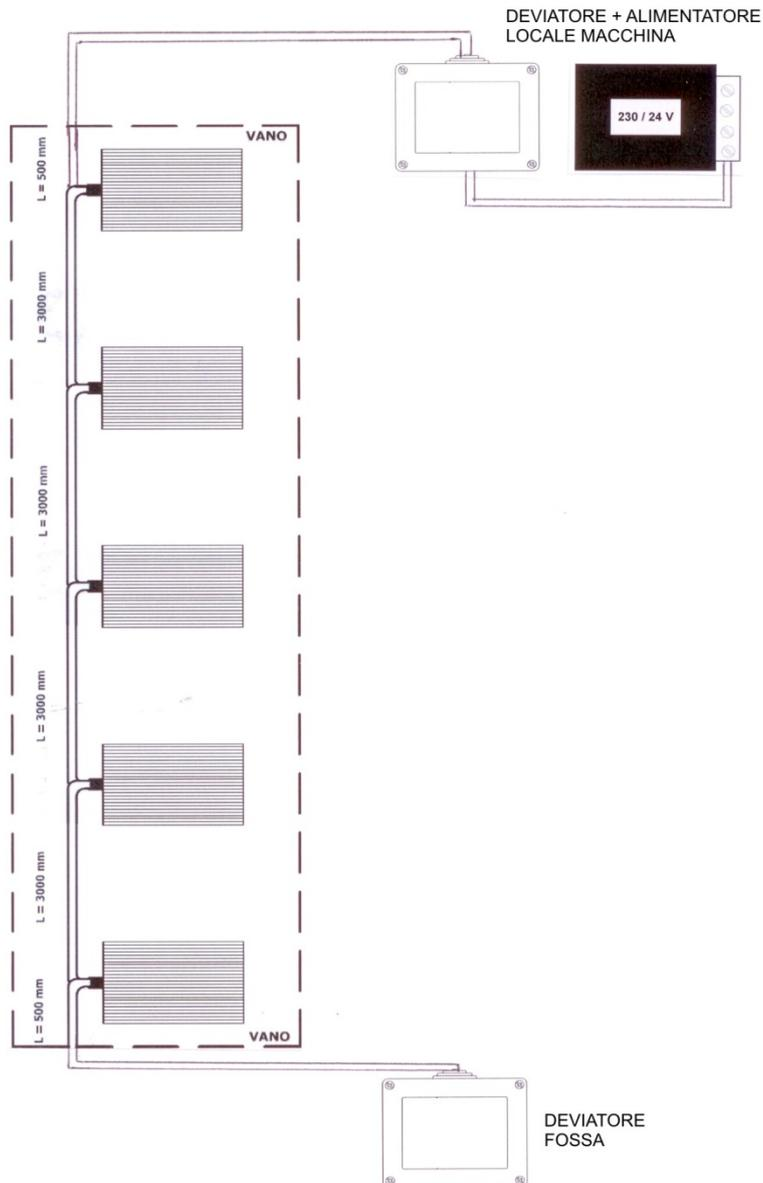
La disposizione delle lampade nel vano è indicativa. Adeguare il numero di lampade in relazione all'illuminamento ed al flusso luminoso necessario. The arrangement of the lamps in the compartment is indicative. Adjust the number of lamps and illumination measured in relation to the luminous flux necessary.
